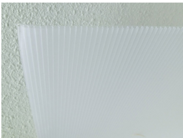
薄い板状のプラスチックダンボール。軽くて取り扱いが容易だが、折れやすい。踏むと中の波型が潰れる。
